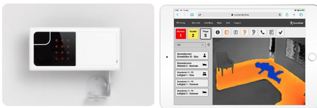
Figur 2: Til venstre vises RoomMate- sensoren som henges på veggen. Til høyre vises bilde av hvordan et anonymisert fallvarsel ser ut for helsepersonell. (Roommate, 2023).
