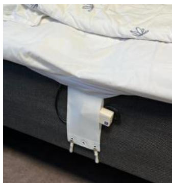
Figur 3: Eksempelbilde på sengesensor (til venstre) og bevegelsessensor (til høyre). Bildene er hentet fra Levanger kommunes digitale visningsrom (Levanger kommune, 2023).
