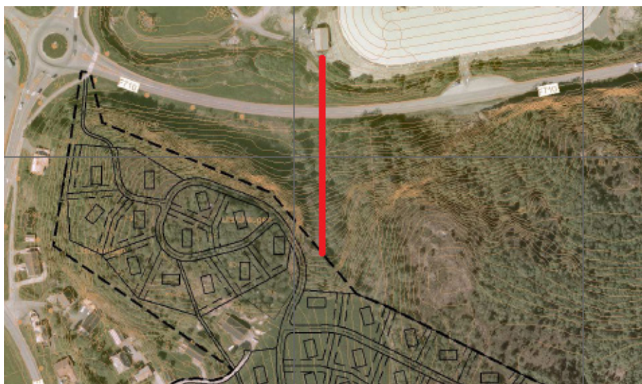
Figur 6 Trase av fjernvarme rør
