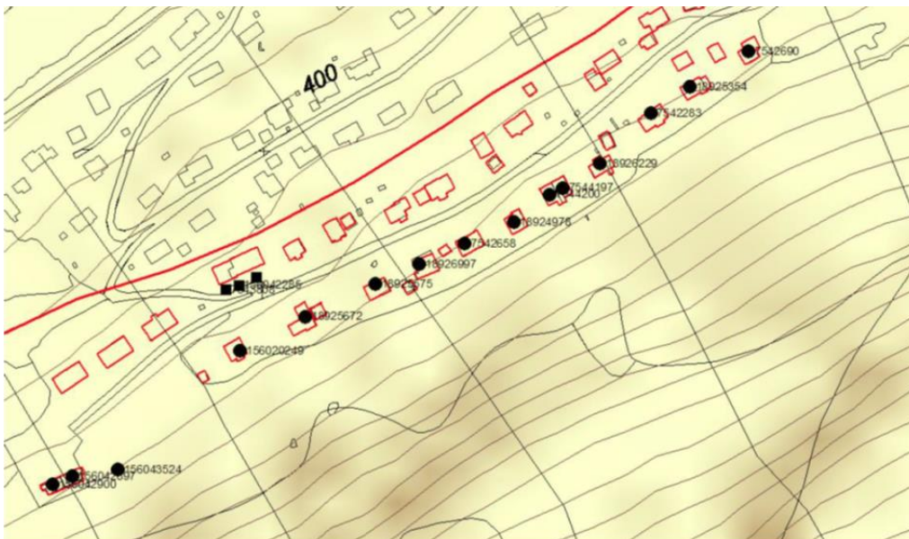
Figur 2 Faregrenser for boligfeltet Ulstad i Lom fra NGI-rapporten «Lom kommune, prioritering av sikringstiltak for eksisterende bebyggelse» (Breien og Kristensen 2010). De merkede bygningene ligger innenfor utslagssonen til skred med 333 års gjentaksintervall, mens den røde linjen angir 1000 års gjentaksintervall.
