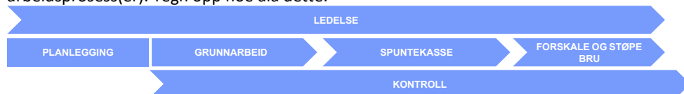
Figur 1: Arbeidsprosess bygging av bru
